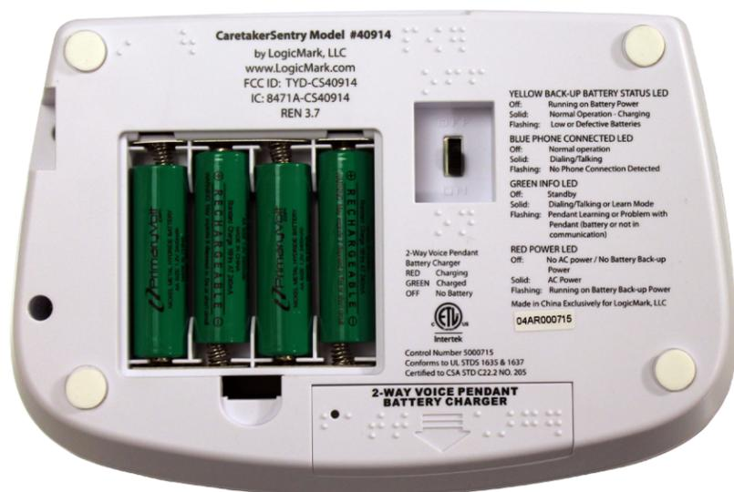
Placez les piles rechargeables vertes dans le compartiment qui se trouve sous le module. **Assurez-vous que l'interrupteur ON/OFF (MARCHE/ARRÊT) est à la position MARCHE.** Vous entendrez le message « Running on Battery Power » (Fonctionnement sur la pile). Le module fonctionnera de cette manière jusqu'à ce que le bloc d'alimentation de l'adaptateur CA soit branché.
